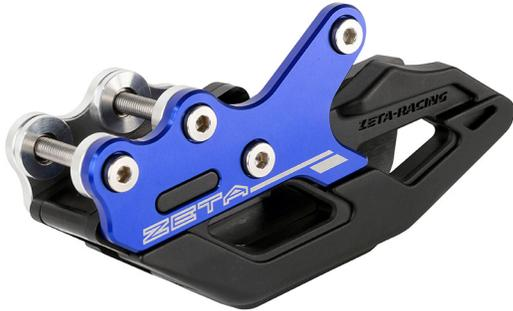
Guía de cadena compuesta de TPU, excelente en resistencia al desgaste y restaurabilidad y placa de duraluminio con procesamiento CNC.
